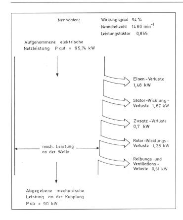
Figur 1 «Leistungsfluss» eines 90-kW-Standardmotors in 4poliger Ausführung
