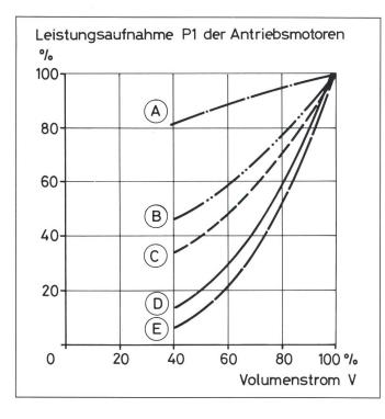
Figur 3 Relativer Leistungsbedarf von Kreiselmaschinen-Antrieben bei verschiedenen Regelmethoden
