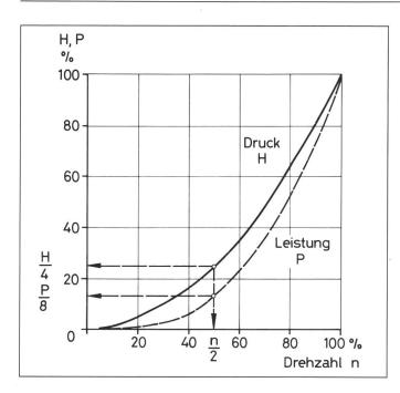
Figur 1 Abhängigkeit der Förderhöhe H und des Leistungsbedarfs P des Kreiselrades von der Drehzahl n
