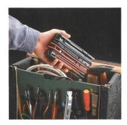
Zum Aufbewahren des Hand-Multimeters, z. B. in der Werkzeugtasche, bleiben die Meßleitungen angesteckt und werden einfach um das Gerät gewickelt. Die Prüfspitzen klemmt man in die Schlitze der Gummiwangen.
