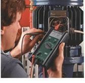
Mit einer eingeklemmten Prüfspitze kann der eine Meßpunkt unmittelbar mit dem Hand-Multimeter abgetastet werden. Man hat die Anzeige dann direkt vor Augen.
