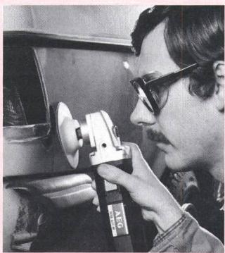
10 000  $\mu$ /min. Damit können alte Farbanstriche entfernt und auch alle Trenn-, Schrubb- und Schleifarbeiten durchgeführt werden. Mit einer Stahldrahtbürste aus dem Zubehör lässt sich der WSE 601 M ferner als Entroster einsetzen. Technische Daten:
