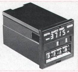
nuell eingestellt. Auf dem vierstöckigen Display wird die ablaufende Zeit kontinuierlich angezeigt. Das DIN-Gehäuse für Fronteinbau misst 48×48 mm. Betriebsspannungen 24 VDC bis 220 VAC. Mit dem potentialfreien Arbeits- bzw. Ruhekontakt können Leistungen von 1 mW bis 2 kW geschaltet werden.
