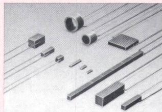
Die Standardabmessungen sind  $1,4 \times 3 \times 9$  bis  $10 \times 10 \times 18$  mm und die Verstellkraft liegt im Bereich von 14 bis 350 kg bei 100 V. Der Hub beträgt 0...15 µm. Für grössere Hübe können Aktuatoren in Serie geschaltet werden. Anwendung finden die Verstelleinheiten in piezoelektrischen Printern, piezoelektrischen Relais und Ventilen, piezoelektrischen Pumpen und für
