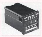
nuell eingestellt. Auf dem vierstelligen Display wird die abgelaufene Zeit kontinuierlich angezeigt. Das DIN-Gehäuse für Fronteinbau misst 48×48 mm. Betriebsspannungen 24 VDC bis 220 VAC. Mit dem potentialfreien Arbeits- bzw. Ruhekontakt können Leistungen von 1 mW bis 2 kW geschaltet werden.
