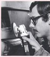
10 000 µ/min. Damit können alte Farbanstriche entfernt und auch alle Trenn-, Schrupp- und Schleifarbeiten durchgeführt werden. Mit einer Stahldrahtbürste aus dem Zubehör lässt sich der WSE 601 M ferner als Entroster einsetzen. Technische Daten:
