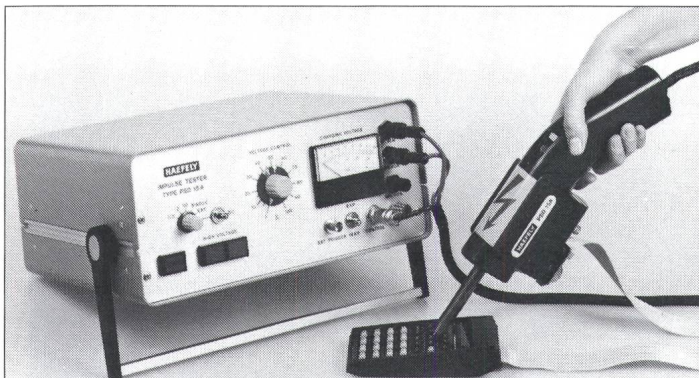
Type PSD 15 A für die Simulation von Entladungen statischer Energie bis 15 kV, nach IEC 801-2; Typ RSD 25 A bis 25 kV
