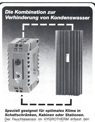
Taupunkt. Kombiniert mit einem Heizgerät verhindert er somit die Bildung von Kondenswasser. Mit dem ebenfalls eingebauten Temperaturregler kann gleichzeitig die gewünschte Lufttemperatur erreicht werden.
