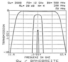
Figur 5 Dämpfungszunahme durch Verkleinerung der Bandbreite
