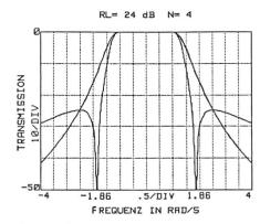
Figur 6 Berechnete Chebyshev- und Pseudo-Chebyshev-Verläufe
