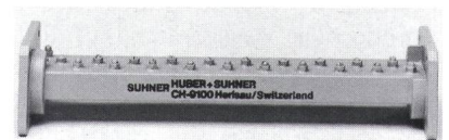
Figur 4 Beispiel eines Hohlleiterfilters Mittenfrequenz 12 GHz Bandbreite 300 MHz
