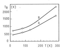
Figur 8 Rauschtemperatur eines Radiometersystems bei verschiedenen physikalischen Temperaturen
