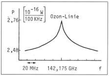
Figur 2 Leistungsspektrum einer Ozon-Emissionslinie
