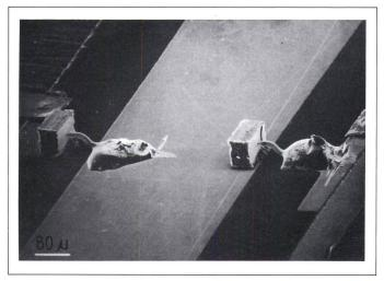
Figur 6 Rasterelektronenmikroskopische Aufnahme eines kontaktierten Diodenpaares
