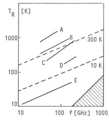
Figur 9 Einseitenband-Systemrauschtemperaturen von Millimeterwellenempfängern
