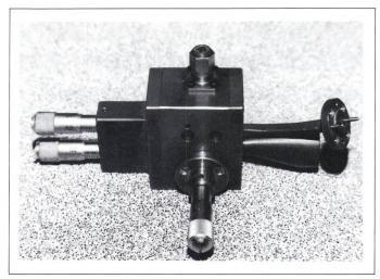
Figur 7 Fertig montierter 180-GHz-Mischer mit Hornantenne
