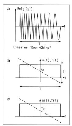
Figur 3 Prinzip der linearen Frequenzmodulation
