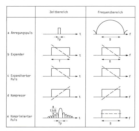
Figur 4 Lineare Frequenzmodulation ohne Wichtung
