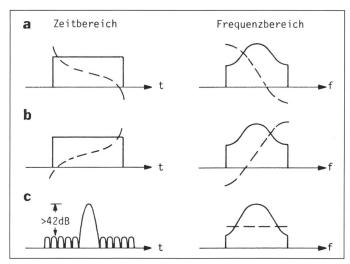
Figur 6 Nichtlineare Frequenzmodulation mit Hamming- oder Taylorwichtung
