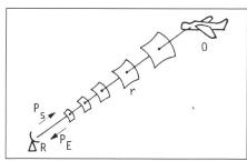
Figur 1 Radarwellenausbreitung  $P_E / P_S = k/r^4$
