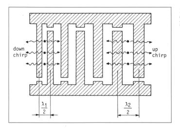
Figur 7 Geometrie eines Interdigitalwandlers
