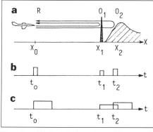
Figur 2 Abhängigkeit der Distanzauflösung von der Pulsdauer
