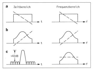
Figur 5 Lineare Frequenzmodulation mit Hamming- oder Taylorwichtung
