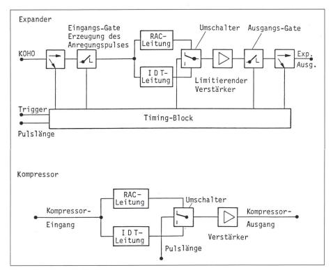
Figur 10 Blockschaltbild eines Pulskompressionssystems
