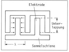
Figur 5 Ein Interdigitalwandler im Detail
