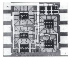
Figur 12 Monolitischer Konverter für das C-Band
