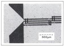
Figur 11 Detailaufnahme eines Lange-Kopplers
