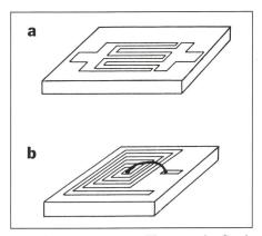
Figur 2 Konzentrierte Elemente in Streifenleitungsschaltungen
