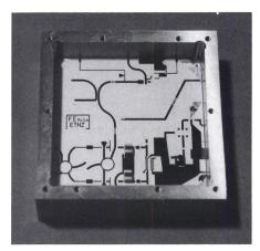
Figur 8 Integriertes MIC/SAW-Empfangsteil
