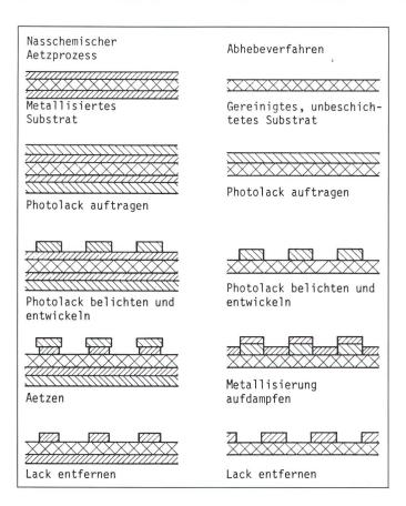
Figur 6 Bessere Auflösung bringt hier ent-Herstellungsprozesse weder das reaktive Ionenätzen oder Links: nasschemischer das sogenannte Abhebeverfahren (Lift-Atzprozess Rechts: Abhebeverfahren (Lift-off) Substrat /// Metall **Photolack**
