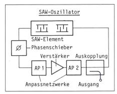
Figur 9 Funktionsweise eines SAW-Oszillators
