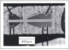
Figur 10 Aufnahme einer SAW-Verzögerungsleitung
