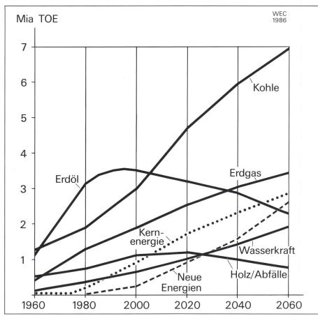
Figur 3 Energieverbrauch nach Energieart (Szenario C: Wachsende Spannungen)
