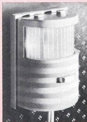
Das Gerät erfasst in vertikaler Richtung auf mehreren Ebenen und eignet sich deshalb auch für die Montage über Kopfhöhe. Das Innengerät Typ 31 wird mit einem Handschalter geliefert, an dem das Licht dauernd ein-, aus- oder auf Automatik gestellt werden kann. Damit können Räume bis  $200\text{ m}^2$  lückenlos überwacht werden, wodurch gewährleistet wird, dass das Licht eingeschaltet bleibt, solange sich eine Person im überwachten Raum bewegt.
