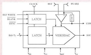
Zusammengesetzte Synchronisierungs- und Blank-Eingänge erzeugen die spezifischen Ausgangspegel, welche zur Ansteuerung des vertikalen und horizontalen Strahlenrücklaufes im Monitor notwendig sind. Eine auf dem Chip integrierte Spannungsreferenz vereinfacht den Systemschaltungsentwurf.
