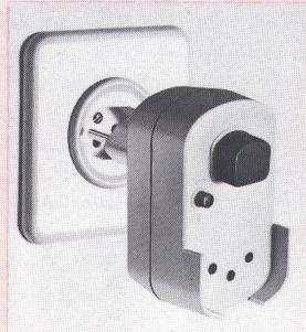
ausgerüstet, die bei Gefahr innerhalb  $20/1000$  s den Strom unterbrechen. Der Adapter wird direkt in die Steckdose eingesteckt und erfüllt so die Forderung, dass ortsveränderliche FI-Schutzschalter so nahe wie möglich an die ortsfeste Installation anzuschliessen sind. (Julius Fischer AG, 8021 Zürich)
