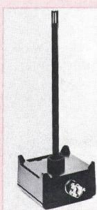
zeichnet werden. Die Eichung der Fühler lässt sich direkt vor Ort mit Hilfe eines für diesen Zweck gebauten elektronischen Referenzgebers HMK 20 durchführen. Als Ausgangssignal steht ein Strom von 4 bis 20 mA bei einer Betriebsspannung von 10 bis 35 VDC zur Verfügung. Der Arbeitstemperaturbereich liegt bei minus 5 bis plus 55 °C.
