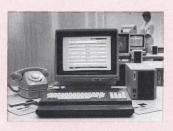
Neben dem «Standard-Mupid» verfügt der «Komfort-Mupid» über einen zusätzlichen Permanentspeicher von 128 K, der gegen Stromausfall gesichert ist. Das heisst für den Benutzer: Speichern beliebiger Daten und Programme, die dann jederzeit ohne Vtx-Verbindung und etwa 30mal schneller abgerufen werden können.
