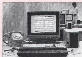
Neben dem «Standard-Mupid» verfügt der «Komfort-Mupid» über einen zusätzlichen Permanenten Speicher von 128 K, der gegen Stromausfall gesichert ist. Das heisst für den Benutzer: Speichern beliebiger Daten und Programme, die dann jederzeit ohne Vtx-Verbindung und etwa 30mal schneller abgerufen werden können.
