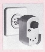
ausgerüstet, die bei Gefahr innert <sup>20</sup>/<sub>1000</sub> s den Strom unterbrechen. Der Adapter wird direkt in die Steckdose eingesteckt und erfüllt so die Forderung, dass ortsveränderliche FI-Schutzschalter so nahe wie möglich an die ortsfeste Installation anzuschliessen sind.
