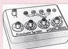
mit 0,1°C Auflösung von -100°C bis +500°C dekadisch eingestellt. Präzisionswiderstände bilden das Temperaturverhalten für Pt-100-Messwiderstände nach. Damit werden viele Aufgaben in Chemie-, Mess-, Regel-, Medizin- und Hausgeräte-technik, Lebensmit-telindustrie, Fahrzeugbau, Luft- und Raumfahrt und Ener-
