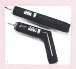
für 450 Gewindeschrauben oder 120 Holzschrauben 3×17 mm. Das Gerät mit 36 mm Ø kann von der Stabform in eine Pistolenform abgewinkelt werden. Die Drehmomenteinstellung ist von 0,4 bis 2,5 Nm stufenlos einstellbar. Eine Rutschkupplung schützt vor Überbelastung, und zwecks manueller Weiterarbeit kann der Motor blockiert werden. Technische Daten:
