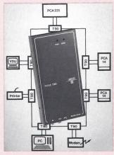
Kommunikationsnetz an, das zu günstigen Preisen den Aufbau eines solchen Netzes (auch nachträglich) möglich macht. Es gestattet den Anschluss beliebiger Geräte, die über eine serielle Datenschnittstelle RS 232c oder 20-mA-Stromschleife verfügen. Dies mit Baudraten zwischen 75 und 9600 Bit/s. Somit können Prozess-Computer, Personal-Computer, speicherprogrammierbare Steuerungen ebenso angeschlossen werden wie Terminals, Drucker, Kartenleser, Temperatur-Erfassungsgeräte
