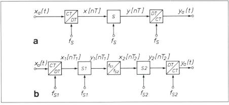
Figur 47. Diskrete Verarbeitung eines analogen Signals
