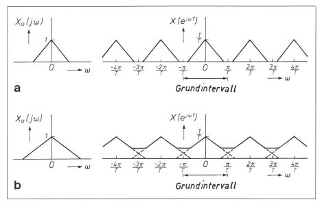
Figur 44. Abtasttheorem
