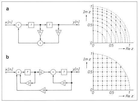
Figur 55. Pole eines Digitalfilters
