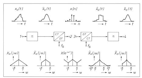
Figur 45. Praktische Abtastung und Rückgewinnung
