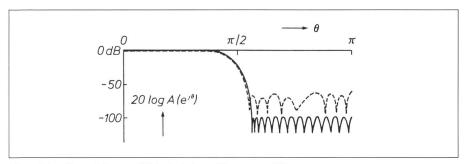
Figur 54. Quantisierungsfehler bei einem Transversalfilter
