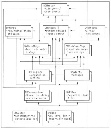
Figur 2. Modulstruktur der Dialogmaschine [16]
