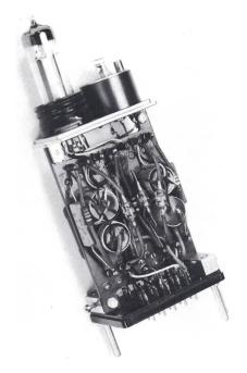
Figur 2. Steckbare Baugruppe der ERMETH (1954)
