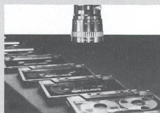
Die Anwendung wird an der Maschine, ohne Entwicklungssystem und ohne mühsam compilierter Programme konfiguriert und getestet. Um auch bei variierenden Lichtverhältnissen höchste Zuverlässigkeit zu gewährleisten, arbeitet Itran mit der sogenannten Grauwertana-
