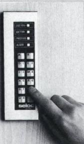
Elektromagnet dafür, dass die Riegel zurückgezogen werden. Die Tastatur ist in einem Stahlgehäuse wasserfest vergossen.
