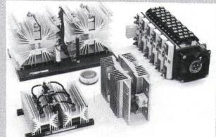
geliefert werden. Nach vorgegebenen Eckdaten des Kunden werden Konstruktionsvorschläge dimensioniert und gemeinsam zur endgültigen Lösung erarbeitet. Die Sätze können bereits ab geringen Stückzahlen kostengünstig gefertigt werden. Alle üblichen Kühlungsvarianten, wie Luft-, Wasser- und Ölkühlung, sind realisierbar. (BBC Normelec, 8953 Dietikon)
