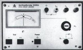
Die Skala des Zeigerinstrumentes ist mit Pfeilen versehen, die den Drehsinn des Digitaldrehknopfes für den Nullabgleich angeben. Die Fehlerentfernung wird in % der gesamten Leitungslänge angegeben. Für die Messung der absoluten Kapazität bei alladrigem Abriss stehen zwei Messbereiche zur Verfügung.
