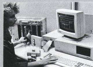
Die Prozesssignale werden zyklisch erfasst, gemeldet und zur aktiven Steuerung und Regelung verwendet. Um das Prozessgeschehen zu verfolgen, sind bis zu 20 Abbilder auf dem Bildschirm darstellbar. Jede Signaländerung wird auf dem Drucker mit der aktuellen Uhrzeit protokolliert. Damit bei Störungen schnell eingegriffen werden kann, ist es möglich, zu-
