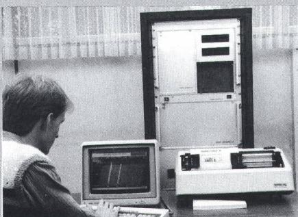
Beim SAVAS/TVM 50 handelt es sich um ein Datenakquisitionssystem für permanente Vibrationsüberwachung und
