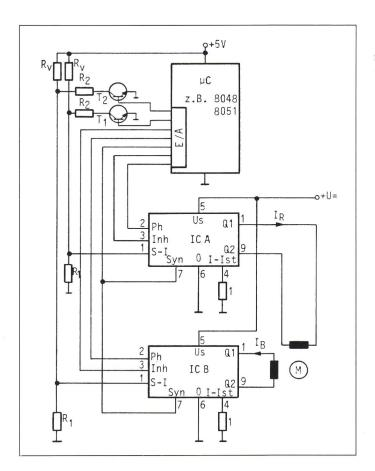
Fig. 9 Mikroprozessorgesteuerter Zweiphasenschrittmotor
