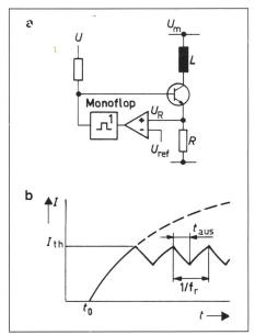
Fig. 2 Prinzipschaltung (a) und Stromverlauf (b) der Choppersteuerung
