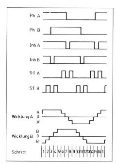
Fig. 11 Signale am Ausgangsort des Mikrocomputers für Viertelschrittbetrieb
