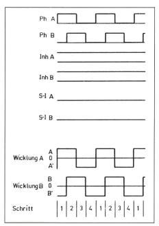
Fig. 10 Signale am Ausgangsort des Mikrocomputers für Vollschrittbetrieb
