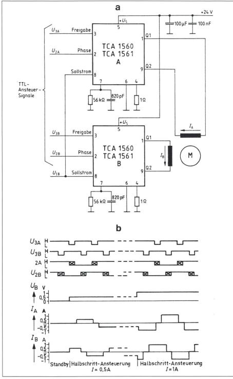
Fig. 8 Anwendungsschaltung (a) und Impulsdiagramm (b) dazu
