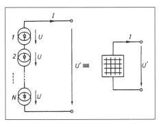
**Fig. 3** Mise en série des cellules photovoltaïques Symbole d'un panneau résultant
