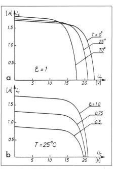
Fig. 1 Caractéristiques d'un panneau composé de 36 cellules photovoltaïques
