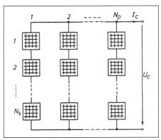
Fig. 4 Assemblage de panneaux en combinaison série-parallèle
