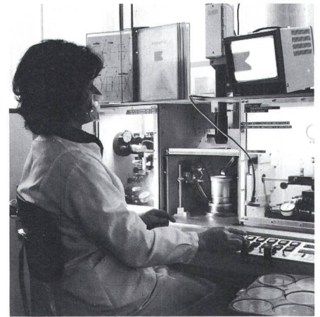
Fig. 6 Herstellung der doppelt positiven Randkontur an Hochspannungthyristoren durch Sandstrahlen
