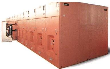
BBC-Mittespannungsschaltfelder für Innenraumaufstellung gibt es für Spannungen bis 36 kV, 50 und 60 Hz, Nennströme bis 4000 A und Kurzschlussfestigkeit bis 50 kA.
