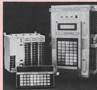
Beide SPS-Systeme von Gould sind mit dem tragbaren Programmiergerät PP 0110 programmierbar. Es lässt sich direkt auf die Steuerung stecken. Programmiert wird mit einer Anweisungsliste. Auch bei ungünstigen Lichtverhältnissen
