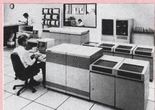
Die ersten Produkte mit der HP Precision Architecture sind Computer, welche die kommerzielle Computerfamilie HP 3000 im oberen Bereich erweitern. Die beiden Rechner mit der Bezeichnung HP 3000 Serie 930 und Serie 950 werden bei voller Kompatibilität mit den bisherigen HP-3000-Modellen eine Systemleistung bieten, die bis zu dreimal die Leistung des derzeitigen Spitzenmodells der Familie HP 3000, der Serie 68, übertrifft.
