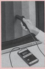
Fertigung, für die Messung der Leuchtdichte von Monitoren, Leuchtwannen oder Verkehrsschildern erfolgen; in jedem Fall ist er ein unentbehrliches Hilfsmittel.
