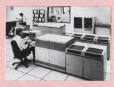
Die ersten Produkte mit der HP Precision Architecture sind Computer, welche die kommerzielle Computerfamilie HP 3000 im oberen Bereich erweitern. Die beiden Rechner mit der Bezeichnung HP 3000 Serie 930 und Serie 950 werden bei voller Kompatibilität mit den bisherigen HP-3000-Modellen eine Systemleistung bieten, die bis zu dreimal die Leistung des derzeitigen Spitzenmodells der Familie HP 3000, der Serie 68, übertrifft.
