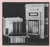
Beide SPS-Systeme von Gould sind mit dem tragbaren Programmiergerät PP 0110 programmierbar. Es lässt sich direkt auf die Steuerung stecken. Programmiert wird mit einer Anweisungsliste. Auch bei ungünstigen Lichtverhältnissen sind Kontrollen anhand der beleuchteten LCD-Anzeige unproblematisch. Das PP0110 verfügt ausserdem über eine Schnittstelle zur Datensicherung mit einem Kassettenbandgerät.
