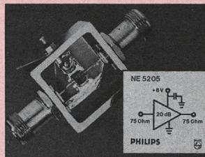
Für die Speisung werden 6 Volt benötigt, der typische Stromverbrauch beträgt 24 mA. Externe Komponenten sind nicht notwendig, da der Verstärker intern kompensiert ist. Bei der Ausführung im TO-46-Gehäuse fällt die Verstärkung erst bei 650 MHz um 3 dB ab, und der Temperaturbereich erweitert sich auf -55 °C bis +125 °C. Das Bild zeigt das Labormuster eines Breitbandverstärkers mit dem IC NE 5205.
