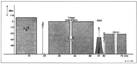
Fig. 1 Stereo-Multiplex-Basisband mit RDS-Signal
