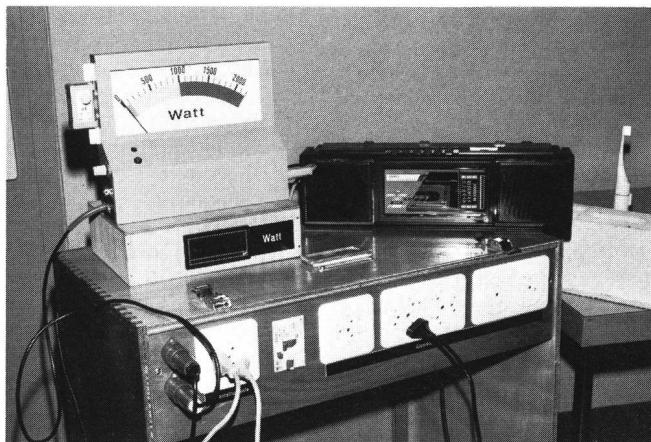
**Un jeu d'instruments qui permet de déterminer la consommation d'électricité des appareils électro-ménagers**
