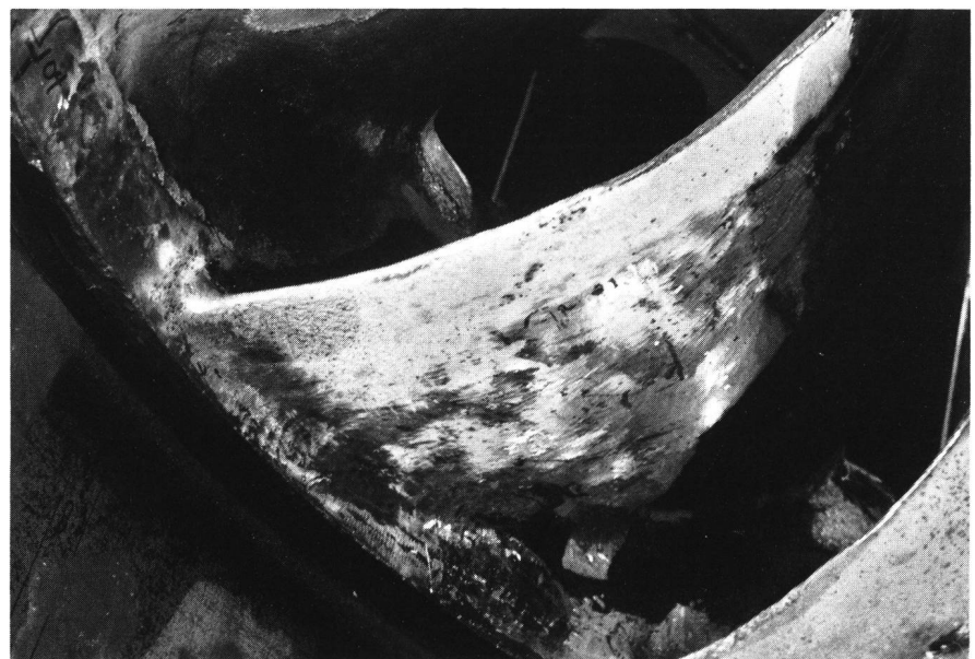
Fig. 3 Beispiel eines inspizierten Turbinenlaufrades mit repariertem Schaufelaustritt
