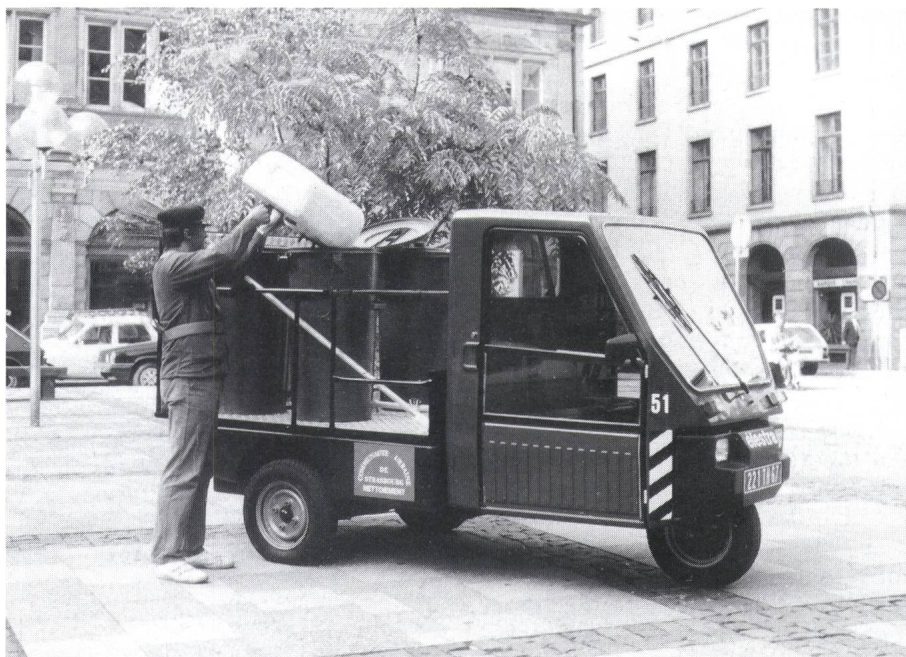
Fig. 2 Elestra avec plateau porte-poubelles en service
