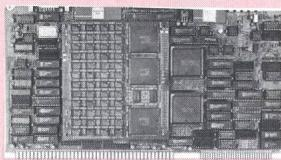
nerhalb eines Bilddurchlaufs ( $\frac{1}{25}$  s) erfasst und abgespeichert werden. Die Kapazität der Kar-te beträgt  $512 \times 512 \times 12$  bit.
