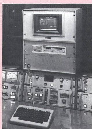
gen für statistische Zwecke wie z.B. Durchschlagsprüfungen ein computergesteuerter Stoßgenerator eine sehr nützliche Lösung.
