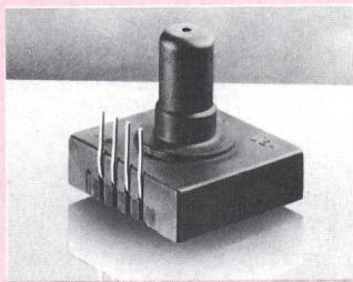
schaften: hohe Empfindlichkeit von 0,6 mV/mbar oder 1 mV/mbar, Linearitätsfehler nur +2% über den ganzen Bereich und Hysterese unter 0,25%, Betriebsspannung 10 V = bzw. 0,2 mA, Einsatz-Temperaturbereich von -40...+85 °C mit Temperaturkompensation zwischen 0...50 °C und dies bei kleinsten Abmessungen von nur 21×21 mm und 24 mm Höhe.
