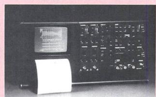
sowohl periodische und transiente Signale bis 10 MHz wie auch Logiksignale aufgezeichnet werden.
