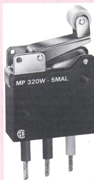
Wichtigste Kenndaten der Schalttypen MP 320 W sind: Gehäuse Polyester UL 94 V-O (selbstlöschend); DIN 41635, Form A Schutzart IP 67 (Watertight) Schaltvermögen: 250 V AC und 10 A AC Anschluss über eingegossene Einzelleiter TEW 105 °C/PVC/AWG 16 CSA-Zulassungs-Nr. 28848 (Certification record 28848)
