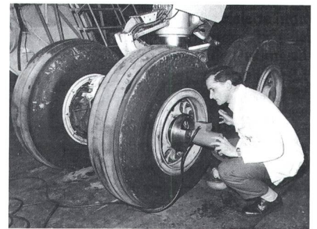
Fig. 5 Zustandskontrolle am Hauptfahrwerk der A 310
