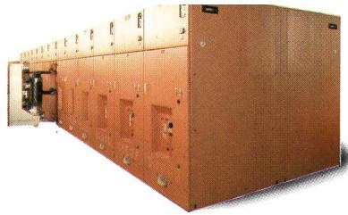
BBC-Mittespannungsschaltfelder für Innenraum-aufstellung gibt es für Spannungen bis 36 kV, 50 und 60 Hz, Nennströme bis 4000 A und Kurzschlussfestigkeit bis 50 kA.
