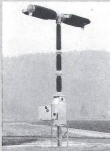
HGF 100 wurden weiterentwickelt: Typ HGF 309 für den Spannungsbereich bis 72,5 kV sowie die Baureihe HGF 200 für den oberen Leistungsbe-reich (Bild). Dieser Schalter weist zwei Unterbrechungsstellen auf und ist für Spannungen von 170...240 kV bei einem Nennstrom von 1250...4000 A konzipiert. Er beherrscht Kurzschluss-Ausschaltströme bis zu 63 kA und ist auf dem bekanntesten Motor-Federantrieb aufge-baut. Weitere Merkmale:
