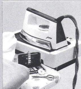
spricht den Sicherheitsvorschriften mit Übertemperatur- und Überdrucksicherung. Eine Dampftaste mit Dauer- und Impulssteuerung übernimmt die Dampfabgabe, Kontrolllampen überwachen die Funktionen, und über einen Präzisionsregler lassen sich die gewünschten Temperaturen einstellen. Verwendet wird normales Leitungswasser; eine Entkalkung des Bügeleisens erübrigt sich.
