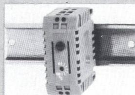
so den genauen Einschaltmoment für Heizgeräte festzustellen. Zusätzlich ist ein Thermostat integriert, einstellbar von 0–60 °C, mit einer Schaltdifferenz von 2 K. Betriebsspannung 110–220 V, 50/60 Hz. Schaltleistung 200 W/AC Aufschnappbar auf DIN-Schienen.
