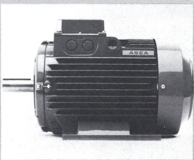
Zu den über 700 Grundausführungen von Elektromotoren mit Leistungen bis 315 kW der Asea fügt sich die MBT-Serie von ganzgekapselten Kurzschlussläufer-Drehstrommotoren mit Nennleistungen von 4 bis 37 kW. Die Größen reichen von 112 M bis und mit 200 L. Die Motoren sind geräuscharm
