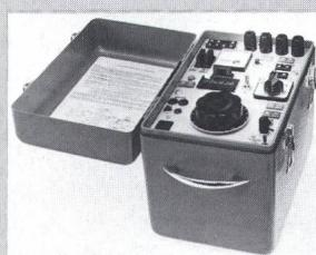
Die Prüfung kann direkt am Einbauort des Relais erfolgen. Die Verbindungsleitungen von den Strom- bzw. Spannungs-wandlern sowie vom Auslösekreis werden gelöst und an das Prüfgerät angeschlossen.
