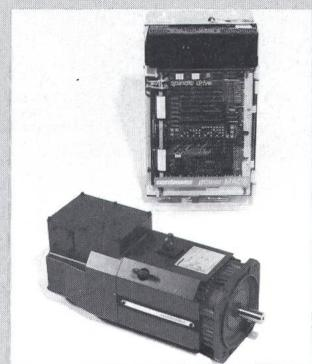
Leistungsbereich von 2,2-37 kW sind die Sollwerte um-schaltbar auf Analog 0-10 V und Binär 12 Bits oder BCD 2 Dekaden. Die Bremsenergien werden ins Netz zurückgeführt. Es sind drei Spindelpositionie-rungen erhältlich:
