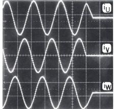
Fig. 7 Messung des Ausschaltvorganges an der Labormaschine
