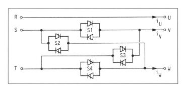
diesem Umschalter werden bei optimaler Ansteuerung folgende Resultate erzielt: Die stationären Werte in allen Grössen werden nach einer minimalen Zeit erreicht. Diese Zeit ist unabhängig von der Impedanz Z der Belastung und im Normalfall (kleine Dämpfungen) wesentlich kleiner als die Zeitkonstante des Stators der Maschine. Der Übergang der Statorströme beim Wechseln des Drehsinns erfolgt kontinuierlich.
