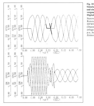
Simulation eines Einund eines Umschaltvorganges auf dem Digitalrechner Statorströme und Rotorspannungen der DFM bei  $|n| = 2 \cdot n_s$ (Daten der Laboranlage, alle Werte in p.u., keine Zeitnormierung)
