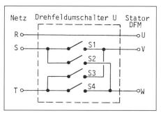
Fig. 3 Drehfeldumschalter U, Schema des Leistungsteils
