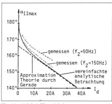
Fig. 16 (Alpha)-Kippwinkel  $\alpha_k = \alpha_{IImax}$  als Funktion von  $I_d$  und  $f_2$
