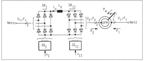
Fig. 1 DFM mit Thyristorumrichter (Stromzwischenkreis)
