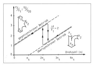
Spannung  $U_2$  in Funktion der Drehzahl und des Betriebszustandes, typische Leistungsflüsse beim Betrieb als Motor  $U_{20}$  Rotorphasenspan-
