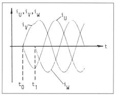
Fig. 8 Simulation eines Einschaltvorganges auf dem Digitalrechner
