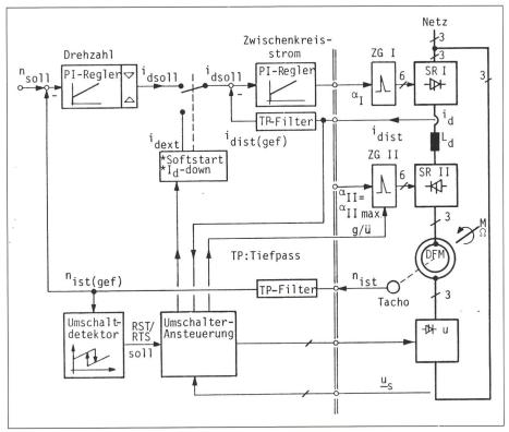
Fig. 15 Regelung einer gegen-/übersynchronen Stromrichterkaskade (1-Ouadranten-Betrieb)
