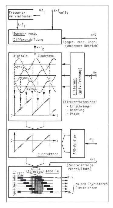
Fig. 13 Blockdiagramm des Zündgerätes ZG<sub>II</sub>
