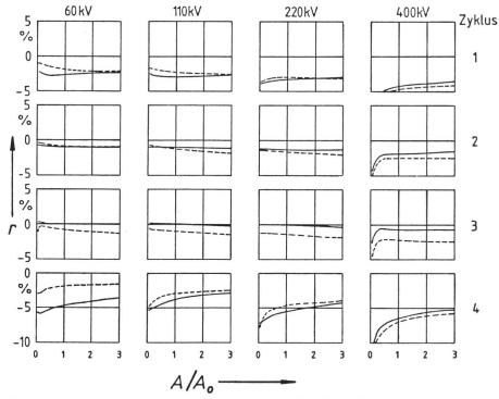
Fig. 6 Relative Abweichungen der Kabelbelastbarkeiten r als Funktion des Kupferleiterquerschnittes ( $A_0 = 1000 \text{ mm}^2$ )
