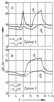
Fig. 4 Zeitlicher Verlauf von Leitertemperatur  $\mathcal{G}_{\rm L}$  und Kabeloberflächentemperatur  $\mathcal{G}_{\rm a}$  für zwei Verlustleistungszyklen nach Figur 3 und für die maximalen Fourierordnungszahlen  $n_{\rm max}=10$  und  $n_{\rm max}=30$
