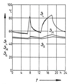
Fig. 5 Zeitlicher Verlauf von Leitertemperatur  $\theta_1$ , Manteltemperatur  $\theta_M$  und Kabeloberflächentemperatur  $\theta_a$  für den Verlustleistungszyklus 4 aus Figur 3
