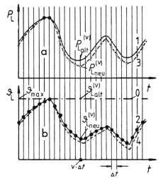
Fig. 2 Prinzipskizze zur Korrektur des Leiterverlustzyklus (a) bezüglich seiner Abhängigkeit von der Leitertemperatur (b)
