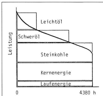
Fig. 3 Geordnetes Lastdiagramm und Einsatz der Kraftwerkstypen
