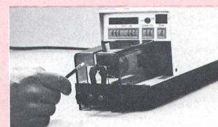
Der Hauptvorteil des Automaten liegt in seiner Programmierbarkeit. Die Abmessungen von 39 Kabeltypen sind vorprogrammierbar. Beim Wechsel von einem Kabeltyp auf den anderen braucht nur ein Voreinstellungsschalter verstellt zu werden. Die Abisoliermesser müssen dabei nicht gewechselt werden. Das Gerät arbeitet ohne Druckluft. (Ernst Hess + Cie, 4006 Basel)
