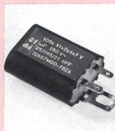
Störschutzkombination X1Y mit einer direkt an die Gerätemasse anschliessbaren Befestigungslasche. Für die beiden Netzanschlüsse der X1-Kapazität stehen wahlweise Faston-kompatible Steckzungen 2,8x0,5 oder flexible, isolierte Litzen zur Auswahl. Auf Anfrage auch mit kundenspezifischen Anschlüssen lieferbar. Litzen-
