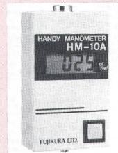
lich und leicht. Die 3 1/2-Digit-LCD-Anzeige erleichtert die Ablesung. Die Daten sind: Messbereich: 0...1000 mbar Messfehler bei 20 °C:  $\pm 0,5\%$  (F.S.) Auflösung: 1 mbar Speisung: 3 V (2 Batterien UM-3) Betriebstemperatur: +5 °C...+40 °C Lagertemp.: -20 °C...+60 °C Abmessungen: 65×40×110 mm Anschluss: PT 1/8" Gewicht inkl. Batterien: 460 g
