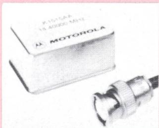
Die Frequenzstabilität erreicht bis zu  $\pm 1 \text{ ppM}$  zwischen  $-30$  und  $+90^\circ\text{C}$ . In diesem Wert sind auch Schwankungen der Umgebungstemperatur, Betriebsspannung, Last und Luftfeuchtigkeit enthalten. Die Alterung erreicht einen Wert von  $1 \text{ ppM/Jahr}$  im Maximum. Mittels eines Potentiometers oder mit einer Regelspannung können die Oszillatoren abgeglichen werden. Es sind auch
