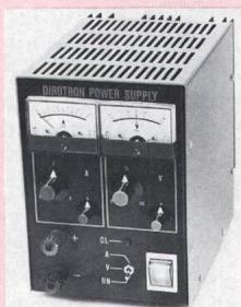
Die Ausgangsspannung zwischen 0,1 und 3 VDC sowie der Ausgangstrom zwischen 0,1 und 4 A können mittels Potentiometern grob und fein eingestellt werden. Eine LED zeigt das Ansprechen der Strombegrenzung an. Das Netzgerät ist kurzschlussfest; ein thermischer Überlastschutz schaltet dieses bei Überschreiten der zulässigen Temperatur vorübergehend ab.
