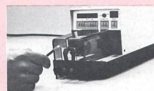
Der Hauptvorteil des Automaten liegt in seiner Programmierbarkeit. Die Abmessungen von 39 Kabeltypen sind vorprogrammierbar. Beim Wechsel von einem Kabeltyp auf den anderen braucht nur ein Vorwahlenschalter verstellt zu werden. Die Abisoliermesser müssen dabei nicht gewechselt werden. Das Gerät arbeitet ohne Druckluft. (Ernst Hess + Cie, 4006 Basel)
