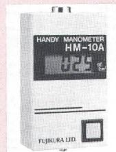
lich und leicht. Die 3 1/2-Digit-LCD-Anzeige erleichtert die Ablesung. Die Daten sind: Messbereich: 0...1000 mbar Messfehler bei 20 °C:  $\pm 0,5\%$  (F.S.) Auflösung: 1 mbar Speisung: 3 V (2 Batterien UM-3) Betriebstemperatur:  $+5\text{ }^{\circ}\text{C}...+40\text{ }^{\circ}\text{C}$  Lagertemp.:  $-20\text{ }^{\circ}\text{C}...+60\text{ }^{\circ}\text{C}$  Abmessungen: 65 x 40 x 110 mm Anschluss: PT 1/8" Gewicht inkl. Batterien: 460 g
