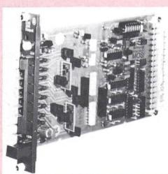
oder zur Schrittmotoransteuerung, wird die 24-V-DC-Ausgabeaugsgruppe EBE 256 eingesetzt. Bei einem Gleichzeitigkeitsfaktor 1 ist jede Stufe mit max.  $420 \text{ mA}$  bei 24 V DC belastbar. Bei 50% ED sind 2100 Schaltungen pro h ( $I_e = 420 \text{ mA}$ , Zeitkonst.  $T = 50 \text{ ms}$ ) bzw. 18 000 ( $I_e = 20 \text{ mA}$ ,  $T = 15 \text{ ms}$ ) erreichbar.
