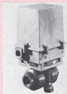
einem Thermoschutz ausgerüstet. Die Öffnungs- bzw. Schliesszeit beträgt 7 s. Das Gerät ist für den Anschluss Wechselspannungen vorgesehen, wobei die Ausführung für 220 V ab Lager lieferbar ist. Die Leistungsaufnahme beträgt 72 bzw. 240 VA.
