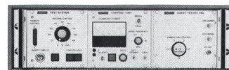
Burst Generator nach IEC TC65/WG4, erzeugt sich repetierende Spikes bis 4 kV Impulsform 5/50 ns 8 kV Modul als Zusatz erhältlich
