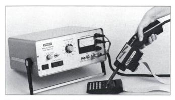
Type PSD 15A für die Simulation von Entladungen statischer Energie bis 15 kV
