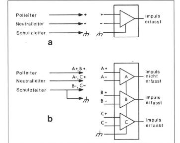
Fig. 4 Messanordnung zur Überwachung einphasiger Wechselströme
