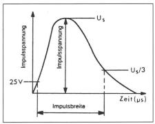
Fig. 2 Definitionen der Impulsspannung
