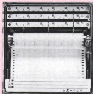
Mit einem Gesamtfehler von 0,5% und einer einstellbaren Ausregelzeit von 1 bis 45 Sekunden eignet sich der KS 3590 zum Aufzeichnen von Prozessvariablen aller Art. Hohe Zuverlässigkeit, einfache Wartung und robuster Aufbau mit den Frontabmessungen 144×144 mm sind weitere Merkmale. Eine Version mit eigensicheren Eingängen für explosionsgefährdete Räume vervollständigt diese Reihe von kompakten Linienschreibern für die industrielle Verfahrenstechnik.
