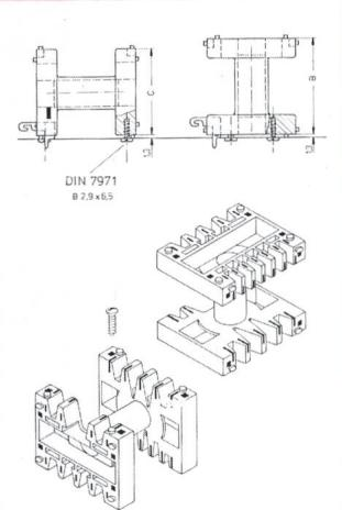
des Spulenköpfers sind den Einbauarten entsprechende Schraublöcher für selbstschneidende Schrauben vorgesehen. Durch die Verstärkung wird auch gleichzeitig eine stabilere Bauart erreicht, die sich nicht nur beim Transport der Spulenkörper aus spröden Kunststoffen bewährt, sondern auch eine stramme Bewicklung ohne Beeinträchtigung der Kernöffnung ermöglicht.
