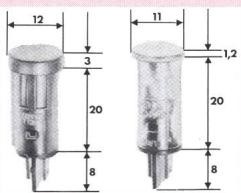
liefern werden. Die Lebensdauer der Glimmlampen wird auf mind. 25 000 h garantiert. Sonderausführungen nach Kundenwunsch werden geliefert. Die grosse Palette von Farben und Signalen machen den Einsatz der Kontrolleuchten vielseitig verwendbar. Durch Eindrücken in die Einbauöffnung von vorne rasten die seitlichen Federklemmen der Signalleuchten ein. Zusätzliche Sicherung durch eine Sperrscheibe ist möglich.
