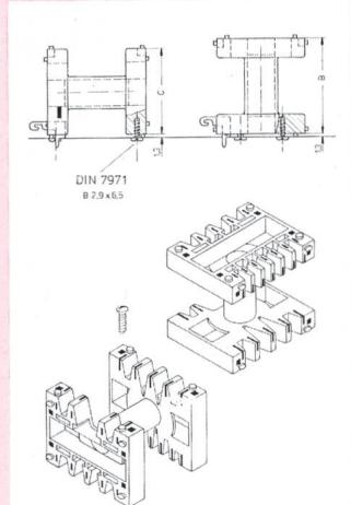
des Spulenköpers sind den Einbauarten entsprechende Schraublöcher für selbstschneidende Schrauben vorgesehen. Durch die Verstärkung wird auch gleichzeitig eine stabilere Bauart erreicht, die sich nicht nur beim Transport der Spulenkörper aus spröden Kunststoffen bewährt, sondern auch eine stramme Bewicklung ohne Beeinträchtigung der Kernöffnung ermöglicht.
