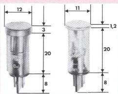
liefern werden. Die Lebensdauer der Glimmlampen wird auf mind. 25 000 h garantiert. Sonderausführungen nach Kundenwunsch werden geliefert. Die grosse Palette von Farben und Signalen machen den Einsatz der Kontrolleuchten vielseitig verwendbar. Durch Eindrücken in die Einbauöffnung von vorne rasten die seitlichen Federklemmen der Signalalleuchten ein. Zusätzliche Sicherung durch eine Sperrscheibe ist möglich.
