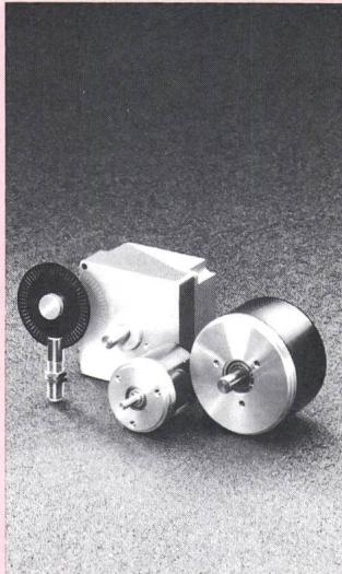
Sensoren zur Winkel- und Drehzahlerfassung an. Die robusten Gehäuse weisen Schutzart IP 64, die Anschlüsse IP 43 oder IP 65 auf. Inkremental-Drehgeber sind in zylindrischer Bauform Ø 55 mm oder Ø 92 mm mit Stecker- bzw. Kabelanschluss, Absolut-Drehgeber in zylindrischer (Ø 92 mm) sowie eckiger Ausführung (100×100 mm) erhältlich. Bevorzugt werden Wellendurchmesser von Ø 6 mm oder Ø 12 mm. Bei einer Speisespannung von 5 bzw.
