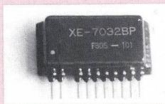
in Messgeräten, -ausrüstungen, Computern usw. Der XE-7032 BP ist zweipolig, der XE-7032 UP der einpolige Typ. Die Pufferung der Daten ist mit Batterien vorgesehen. Die Bauteile sind leicht und brauchen wenig Strom. Einige Daten:
