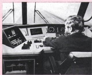
geringe Einbautiefe der AC-Plasma-Displays (75 bis 100 mm) ermöglichen die bedienungskonforme Plazierung in Schienen- und Strassenfahrzeugen.
