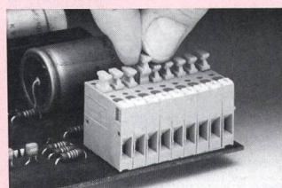
einem dazwischen gesetzten Rasterstück (2,54 mm) weist die neue, praktische Prüf/Trennklemme eine Spannungsfestigkeit von 500 V auf.
