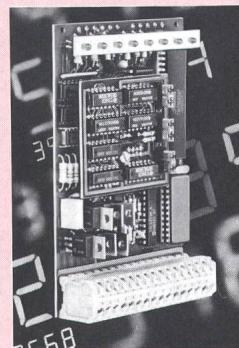
wie sie für Palettiereinrichtungen und in der Holzbearbeitungsindustrie Anwendung finden. Alle Funktionen können über den normalen Befehlssatz aufgerufen werden. Das gleiche Modul lässt sich auch als Impulsgenerator zur Ansteuerung von Schrittmotoren betreiben. Die Betriebs-Software wurde in das Systemprogramm des Zählermodul integriert.
