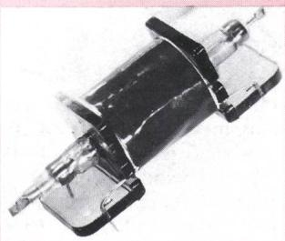
bei 30 MHz mit 8 A belastbar. Spannungen von einigen Tausend Volt sind schaltbar. Die Trennung beträgt -70 dB bei 1, MHz -45 dB bei 30 MHz.
