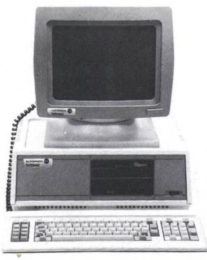
auch während dem Empfangs- und Sendevorgang. Die Nachrichten werden in diesem Fall ebenso wie die Texte auf Disketten gespeichert. Zur Verfügung stehen dabei zwei Floppy-Disk-Laufwerke mit einer Speicherkapazität von je 320 kByte, wählweise auch eine Winchester Hard Disk mit 10 oder 20 MByte. Das System erlaubt die Automatisierung der Übermittlungsvorgänge während der Nacht. Rundschreiben können mit Infratel TX ebenso auf einfache Weise realisiert werden.
