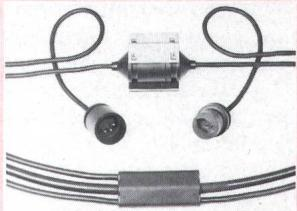
Steckern und deren Abschlusskappen sowie Abzweigstücken in Butanox-Qualität. Die Verlegung der Kabel erfolgt in offenen Kanälen an der Tunneldecke. Um Widerstandsfähigkeit gegen hohe Temperaturschwankungen und gegen die Immissionen von Verkehr und Tunnelreinigung zu gewährleisten, wurde Radox-Material verwendet. Installation und Unterhalt werden durch dieses System einfach, sicher und kostengünstig.
