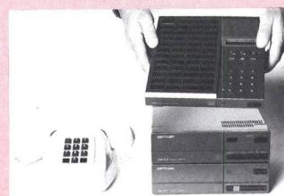
von Elektrogeräten sowie die automatische Weiterleitung von Gesprächsaufzeichnungen an jede gewünschte Telefonnummer (auch Natel, Eurosignal usw.). Ergänzende Module halten Datum und Uhrzeit fest oder erlauben den Anschluss an zwei Amtslinien.
