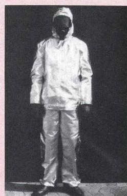
werken oder in der chemischen Industrie bietet der asbestfreie Alwit-Schutzanzug einen hohen Schutz. Er ist nicht nur schwer entflammbar, sondern verfügt auch über eine gute Säure- und Chemikalienbeständigkeit. Dazu ist er antistatisch, besitzt hohe Reiss- und Scheuerfestigkeit und ist sowohl wasch- als auch reini-
