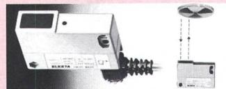
Geliefert wird eine Ausführung mit integriertem Kabelanschluss sowie eine solche mit Stecker. Der Stecker entspricht einem Industriestandard und ist mit einer schraubbaren Ausziehsicherung versehen. Zu den bereits im Gehäuse integrierten, verschiedenen Montagemöglichkeiten kann noch ein universeller Befestigungswinkel geliefert werden.
