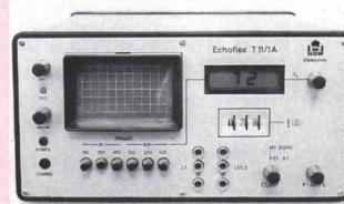
HDW-Elektronik GmbH werden Kabelfehler nach der Impuls-Reflexionsmethode geortet. Dazu werden geeignete Impulse in das Kabel eingespeist, welche an Fehlerstellen (teilweise) reflektiert werden. Sowohl das Sende- als auch das reflektierte Signal werden auf dem Bildschirm dargestellt. Die Fehlerentfernung erscheint als LCD-Anzeige in «m» bzw. «km».
