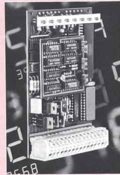
wie sie für Palettiereinrichtungen und in der Holzbearbeitungsindustrie Anwendung finden. Alle Funktionen können über den normalen Befehlssatz aufgerufen werden. Das gleiche Modul lässt sich auch als Impulsgenerator zur Ansteuerung von Schrittmotoren betreiben. Die Betriebs-Software wurde in das Systemprogramm des Zählermoduls integriert.
