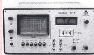
HDW-Elektronik GmbH werden Kabelfehler nach der Impuls-Reflexionsmethode geortet. Dazu werden geeignete Impulse in das Kabel eingespeist, welche an Fehlerstellen (teilweise) reflektiert werden. Sowohl das Sende- als auch das reflektierte Signal werden auf dem Bildschirm dargestellt. Die Fehlerentfernung erscheint als LCD-Anzeige in «m» bzw. «km».
