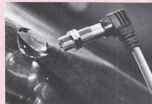
Ausschuss. Die Betätigungs-kraft der Saphir-Tastspitze beträgt 75 g. Zur Befestigung dient das metrische Feingewinde. Speisespannung 24 VAC oder 15 VDC. In Kontroll-Lehren eingebaut, prüft My-Com in der Serienfertigung Länge, Dicke, Rundlauf oder Parallelität. Ferner nimmt der Präzisionsschalter vielfache Aufgaben der Leistungsoptimierung wahr wie Kontrollanschlag bei Positionierungstischen, bei Frä-, Dreh- und Schleifautomaten usw.
