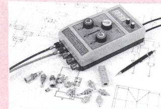
tig zur Verfügung stehen. Standardmäßig können die Regelbereiche 0...4 bar oder 0...2 bar geliefert werden. Der eingebaute piezoresistive Drucksensor hat einen Messbereich von 0...8 bar. Zwei Sicherheitsventile in den Eingangsleitungen sorgen für den Überlastschutz des Gerätes.
