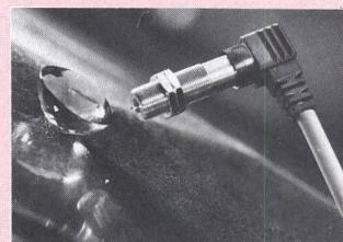
Ausschuss. Die Betätigungs-kraft der Saphir-Tastspitze beträgt 75 g. Zur Befestigung dient das metrische Feingewinde. Speisespannung 24 VAC oder 15 VDC. In Kontroll-Lehren eingebaut, prüft My-Com in der Serienfertigung Länge, Dicke, Rundlauf oder Parallelität. Ferner nimmt der Präzisionsschalter vielfache Aufgaben der Leistungsoptimierung wahr wie Kontrollanschlag bei Positionierungstischen, bei Frä-, Dreh- und Schleifautomaten usw.
