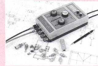
tig zur Verfügung stehen. Standardmäßig können die Regelbereiche 0...4 bar oder 0...2 bar geliefert werden. Der eingebauten piezoresistive Drucksensor hat einen Messbereich von 0...8 bar. Zwei Sicherheitsventile in den Eingangsleitungen sorgen für den Überlastschutz des Gerätes.
