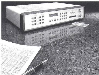
**Der GRETACODER 715 dient zur Authentisierung und Identifikation von Transaktionen im elektronischen Zahlungsverkehr sowie zur Sicherung anderer Meldungen. Die geheimen Schlüssel werden mittels einer elektronischen Speicherkarte eingelesen.**
