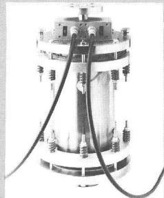
Aussenabmessungen der Zelle betragen 265 mm Ø x 455 mm mit einem Leergewicht von 32 kg und einem Füllvolumen von 4,3 l. Der elektrische Anschluss für Hochspannung (2 kV) und Messstrom erfolgt über einen Lemo-Hochspannungsstecker. Die Messzelle kann an vorhandenen Messbrücken betrieben werden. (Transmetra AG, 8203 Schaffhausen)
