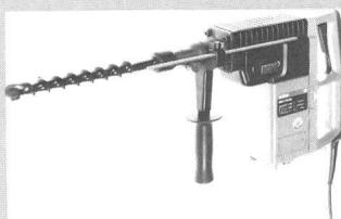
schwinger eignet sich für das Baugewerbe und Baubewerbe und verfügt über einen Bohrbereich von 13 bis 100 mm Durchmesser. Er ist mit einer robusten Vollwellen-Regelelektronik für konstante Drehzahl ausgerüstet. Die für die jeweilige Arbeitsaufgabe richtige Drehzahl, Schlagzahl und Schlagstärke können stufenlos am Stellrad der Elektronik vorgewählt werden: Boherdrehzahl von 120 bis 245 U/min, Schlagzahl von 1300 bis 2650 pro min, Einzelschlagstärke von 1 bis 7 Joule.
