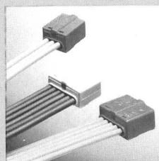
Neben den Steckklemmen mit 3, 5 oder 6 Klemmstellen gibt es die Steckklemmen Typ 2225 mit 1-12 Polen sowie verschiedene Ausführungen: ohne Lösewippe, Lösewippe auf Abgangsseite oder Lösewippe auf Zu- und Abgangsseite. Die Befestigung erfolgt wahlweise über M3-Schraubenbefestigung oder zum Aufstecken auf abgewinkelte Befestigungsnasen mit Kantenmass 3,1 mm oder Spreiznietbefestigung für Blechdicken von 0,6...1,2 mm, Befestigungsbohrung Ø 3,5 mm.
