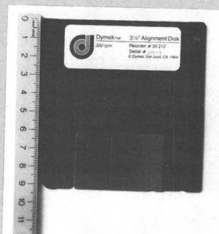
Dymek bietet Alignment-Disketten an, die für einseitige und doppelseitige 3½"-Laufwerke mit 300 bzw. 600 RPM verwendbar sind. Mit den aufgezeichneten Informationen ist es möglich, die Kopfposition bezüglich radialer Abweichung und Azimuth einzustellen. Darüber hinaus kann ein Abgleich von Indexsensor und Spur-0-Detektor erfolgen.
