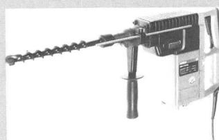
schwinger eignet sich für das Baugewerbe und Baunebengewerbe und verfügt über einen Bohrbereich von 13 bis 100 mm Durchmesser. Er ist mit einer robusten Vollwellen-Regelelektronik für konstante Drehzahl ausgerüstet. Die für die jeweilige Arbeitsaufgabe richtige Drehzahl, Schlagzahl und Schlagstärke können stufenlos am Stellrad der Elektronik vgewählt werden: Boherdrehzahl von 120 bis 245 U/min, Schlagzahl von 1300 bis 2650 pro min, Einzelschlagstärke von 1 bis 7 Joule.
