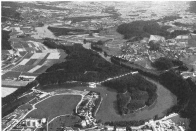
**Das neue Kraftwerk Bremgarten-Zufikon ersetzte das überalterte Kraftwerk Zufikon (gestrichelt eingezzeichnet). Es gestattet eine wesentlich bessere Gefälle- und Wasserausnutzung und trägt gleichzeitig zur Verbesserung des Hochwasserschutzes in der Reussebene bei.**
