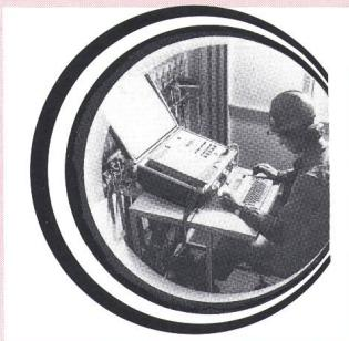
zur Messung des gesamten Netzes. Typ MIC 11 (Fig.) ist zur Messung von Hochleistungsnetzen bestimmt, mit Kurzschlussströmen bis zu 80 kA. Ein tragbarer Klein-Computer ermöglicht die Erstellung eines Messprotokolls. Der EGPE-Hochleistungs-Entlader für Mittelspannungsnetze dient dem Schutz gegen Blitz für die Leitungen, die Blitzableiter und die Transformatoren. Für thermische Messungen eignen sich - die Heizgradstundenzähler (Energie-Verbrauchsüberwachung von Heizanlagen)
