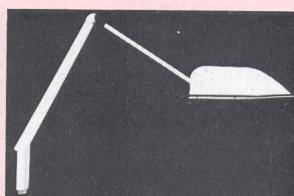
für Sparlampen 11 W (Kompakt-Fluoreszenzlampe PL oder Dulux) zur Verfügung. Sie besitzt einen asymmetrischen Reflektor aus reinem Aluminium 99,9% anodisiert. Die Gelecke sind selbsthemmend, was eine grosse Flexibilität gewährleistet. Lieferbar ist die Leuchte weiß oder braun mit Tischklammer für Platten von 15-110 mm verstellbar oder mit Tisch- oder Wandflansch.
