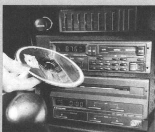
Das Umschalten zwischen Radio, Kassette und CD-Platte erfolgt selbsttätig. Verkehrsfunkdurchsagen können automatisch eingeblendet werden. Der Abspielvorgang kann jederzeit unterbrochen und später lückenlos wieder fortgesetzt werden. Bestimmte Musiktitel lassen sich auf Tastendruck anwählen. Auf einem grossflächigen Display werden die Nummer des laufenden Titels und dessen abgelaufene Spielzeit angezeigt.
