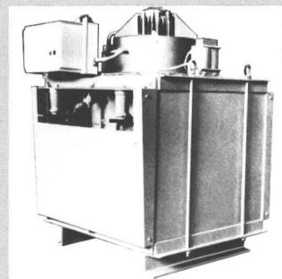
Kühlung dient der Glättung im Gleichstrompfad einer USV-Anlage. Ihre bei 850 A Nennstrom wirksame Induktivität von 3,6 mH soll auch bei Stromstößen von 4500 A um nicht mehr als 20% absinken. Betriebsspannung: 6500 V, Abmessungen: 950×950×1050 mm.
