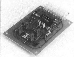
teile: hohe Schrittfrequenzen, schnelle Beschleunigungen, großes Drehmoment, saubere Trennung von Steuerteil und Leistungsteil, externe Motorspannung, kleinere Verluste im Bi-level-Betrieb (speziell im Haltezustand). Der TEA 1012 benötigt eine Speisespannung von 4,5 V bis 16 V und hat eine Stromaufnahme von 4,5 mA bis 18 mA. Der Ausgangsstrom pro Ausgang ist dabei größer als 50 mA. Die zulässige Betriebstemperatur reicht von -20 °C bis +80 °C. Das 16-Pin-DIL-Gehäuse ist aus Kunststoff.
