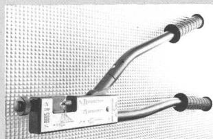
terbrochen werden kann. Das Angebot wird ergänzt durch eine Handpresszange zum Verpressen von Verbünden bis zu 16 mm<sup>2</sup>. Diese ist in einem Kunststoffkoffer untergebracht, in welchem das Grundwerkzeug und die verschiedenen Einsätze mitgeführt werden.
