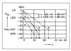
Fig. 2 Verschiedene Kombinationen im Reichweitenvergleich am Beispiel einer optischen 4-Mbaud-Verbindung
