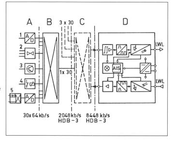
stung, führen in der Leitungsendausrüstung zu einem Alarm und werden teilweise als AIS (Alarm Indication Signal) an die nachfolgende Strecke weitergemeldet. Die erzielbaren Verstärkerfeldlängen liegen bei diesem mit einem 1300-nm-Laser ausgerüsteten System typischerweise bei 25 bis 40 km.
