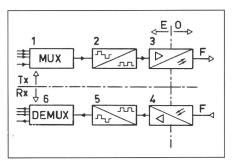
Fig. 1 Prinzip einer optischen Mehrkanalübertragung
