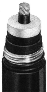
Polymerkabel XCUW-T 1 x 300 m 2 150/87 kV
