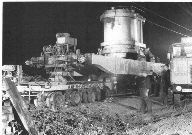
Wegfahrt eines von der Bahn auf die Strasse umgesetzten Transformators. Gut ersichtlich ist am vorderen Ende des Tragrahmens die motorhydraulische Hebevorrichtung des Tragrahmens.
