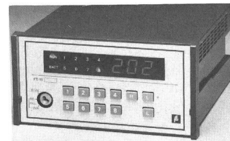
Universalzähler FT-11 mit neuartigem Achtfach-Matrixspeicher
