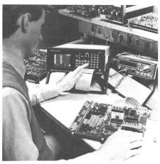
Fig. 4 Logikanalysatoren gestatten das gleichzeitige Erfassen von Datenströmen bei einer Vielzahl von Knotenpunkten
