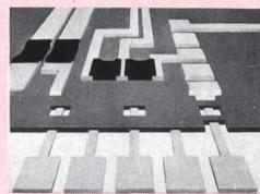
Die Leitpasten lassen sich mit einer Konturenshärfe von 250 µm drucken. Die Mehrlagen-Isolierpaste ermöglicht eine Auflösung von 200 µm breiten Durchkontaktierungslöchern hoher Druck-Geschwindigkeit (15 cm/s), und die Einkapselungspaste 9537 schützt die Schaltung gegen Umwelteinwirkungen und mechanische Beschädigung.
