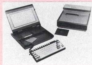
einem Aktenkoffer untergebracht ist. Zum Gerät gehört das Software-Paket, bestehend aus WordStar, InfoStar+, Calc-Star, Übungen und Lektionen, GW-Basic und MSDOS. Ein Batterien-Satz, der sich bei Arbeiten am Netz automatisch wieder auflädt, ist eingebaut.
