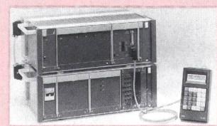
aber auch Schutzgeräte mit nur einer Messgröße, wie abhängige oder unabhängige Stromrelais, Spannungsrelais usw. prüfen - und zwar in der Anlage wie im Entwicklungslabor. In der Standardausführung liefert das Gerät drei Spannungen und einen Strom als Prüfgrößen. Diese stehen in folgenden Kombinationen zur Verfügung:
