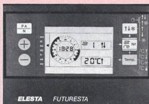
Seine einfache Bedienung wurde durch eine ganze Reihe von Massnahmen erreicht, so etwa durch die Unterscheidung von vier Bedienungsebenen, entsprechend der Bedeutung und Häufigkeit der einzelnen Bedienungsvorgänge. Dem Anlagenbesitzer präsentiert das Gerät im Normalzustand nur die erste Bedienungsebene für die gebräuchlichen Bedienungsvorgänge. Alle selten gebrauchten Bedienungselemente, die den Überblick erschweren würden, sind abgedeckt.
