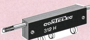
(mit Widerstandswerten von  $1 \dots 20 \text{ k}\Omega$ ) wie eine in Drahtleitplastik erhältlich. Die letztere ist ein platzsparendes Hybridwiderstandselement, als Rheostat anwendbar, mit hoher Lebensdauer und feiner Auflösung. Die Linearität ist besser als 0,25%, der Standard-Widerstand beträgt  $10 \text{ k}\Omega$ .
