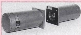
(Ex) D 3N G5 nach VDE 0170/0171. Die Laser-Lichtschranke vom Typ LP 100 Ex besteht aus den Baugruppen Sender (mit eingebautem Netzteil) und Empfänger. Das Gerät kann sowohl im Linear- als auch Reflexbetrieb, in diesem Fall mit einer Nennreichweite von 400 m, eingesetzt werden. Wegen der hohen Leistungsreserve können auch schlechtreflektierende Oberflächen, z.B. Holz, Kunststoff, Hartpapier usw. abgetastet werden. Als Betriebsarten werden Hell- und Dunkeleinschaltung angeboten. Zur Si-
