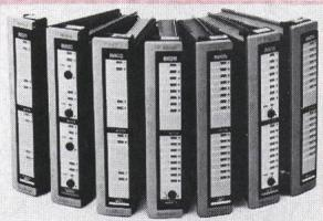
gehört die umfassende Ein-/Ausgangs-Modulpalette Serie 800. Neben den diskreten 16-Punkt-Modulen sind heute kostengünstige 32-Punkt-24-V-DC-Module lieferbar, ebenso Analog- und Registermodule:
