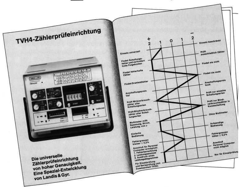
Die portable Zählerprüfeinrichtung TVH4 ist eine neuartige, kompakte Meß-Einrichtung für die Prüfung von Zählern am Einsatzort.
